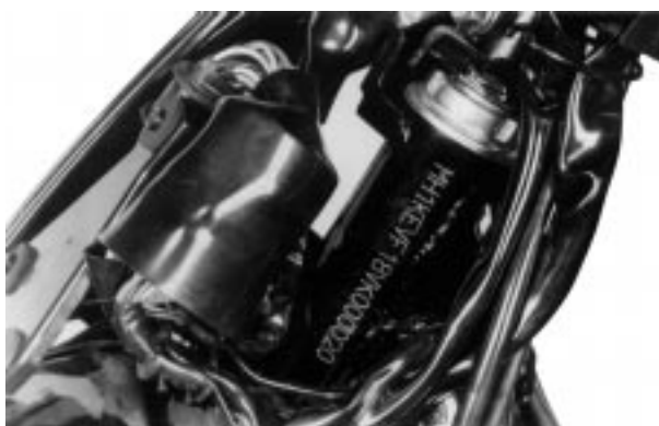
Nomor seri rangka dicetak pada bagian kiri kepala kemudi
