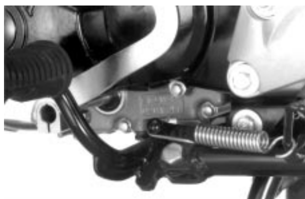
Nomor seri mesin dicetak pada bagian kiri bawah daripada bak mesin
